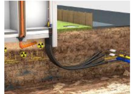
Garantiert radon-, gas- und wasserdichte Durchführungen für Hausanschlüsse bieten Schutz für Bewohner und Gebäude.
